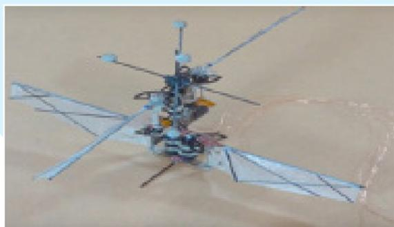
également pour la détection des obstacles. Grâce à la rétroaction du courant permettant de surveiller la charge instantanée de l'aile, l'oiseau peut également détecter son environnement. Ce retour de courant, en vol bas par exemple, permet au robot de surveiller sa garde au sol tout en suivant le terrain. Elle permet également de détecter le moment où les ailes entrent en collisions avec des objets.
